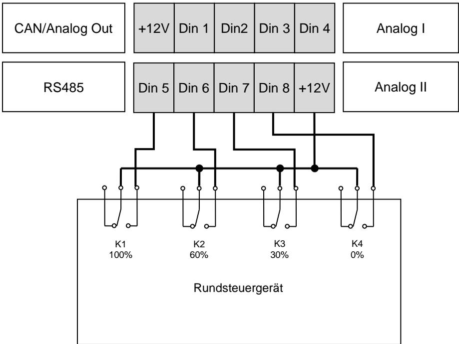
Abbildung 41: Anschlussplan Rundsteuerempfänger
