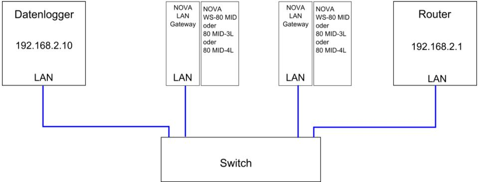
Abbildung 36: Anschlussplan TIP NOVA LAN Gateway
