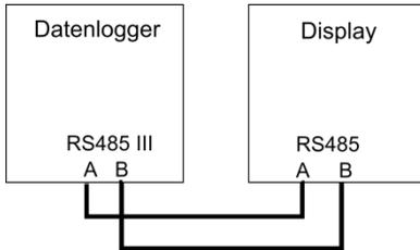
Abbildung 27: Anschlussplan Großdisplay
