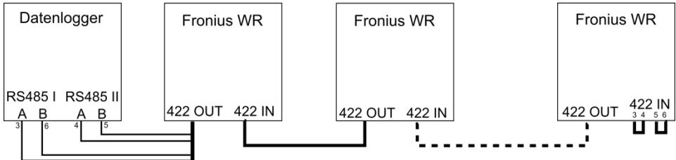
Abbildung 11: Anschlussplan Fronius
