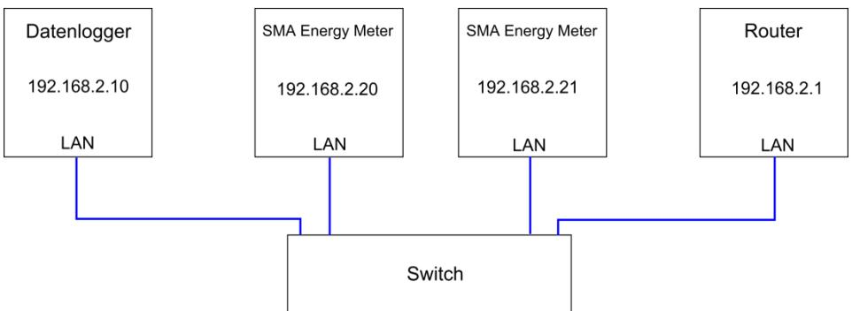
Abbildung 35: Anschlussplan SMA Energy Meter
