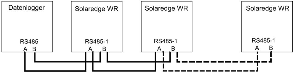
Abbildung 16: Anschlussplan Solaredge
