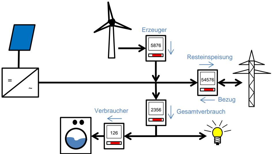
Abbildung 39: Stromzählerübersicht
