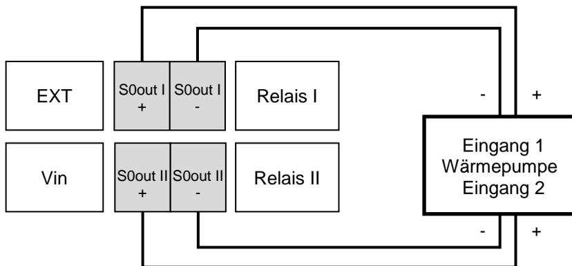
Abbildung 49: Anschlussplan Wärmepumpe
