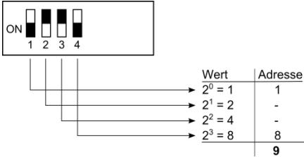
Abbildung 29: DIP-Schalter KMTronic
