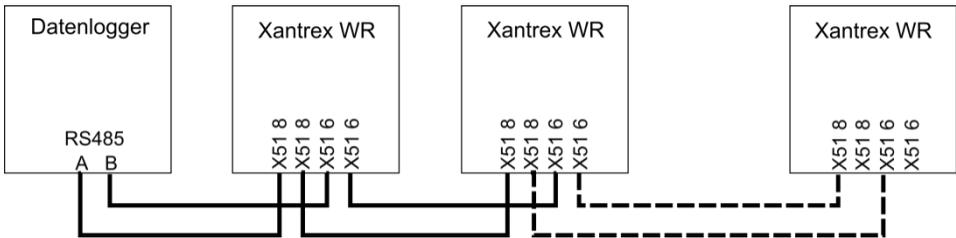
Abbildung 20: Anschlussplan Xantrex
