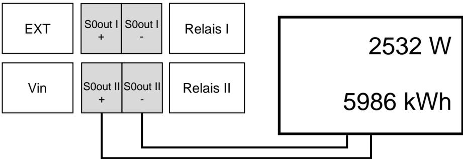
Abbildung 47: Anschlussplan S0 Großdisplay
