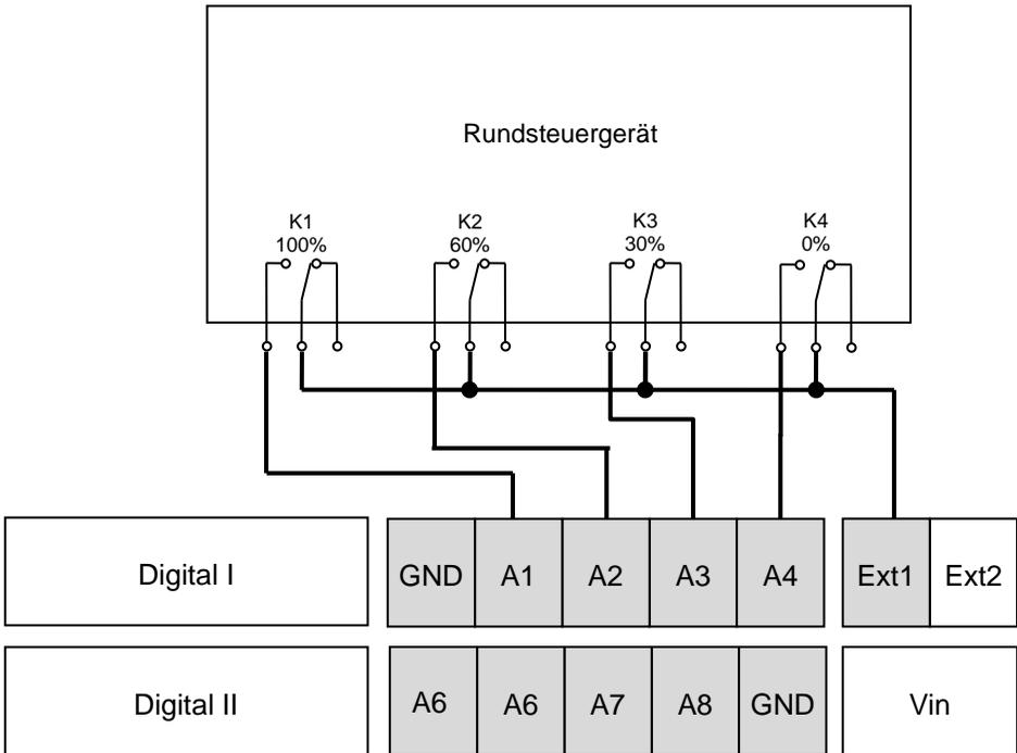
Abbildung 45: Anschlussplan Rundsteuerempfänger
