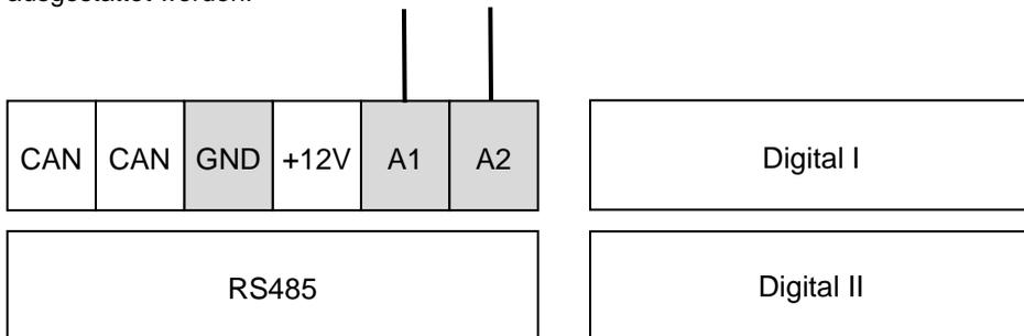
Abbildung 51: Anschlussplan Analog Out
