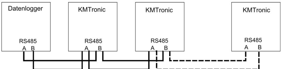
Abbildung 28: Anschlussplan KMTronic Relaiskarte
