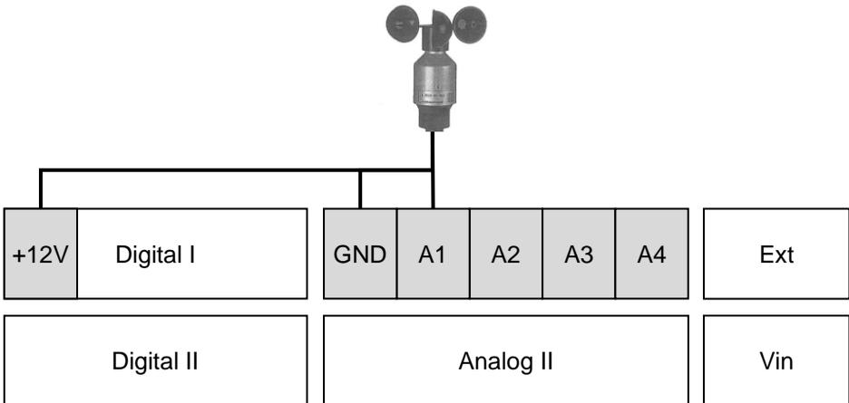
Abbildung 44: Anschlussplan Windsensor
