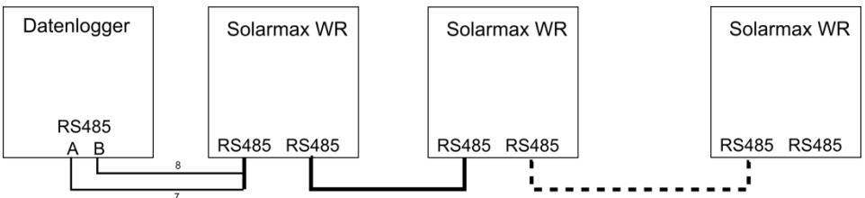
Abbildung 4: Anschlussplan Solarmax
