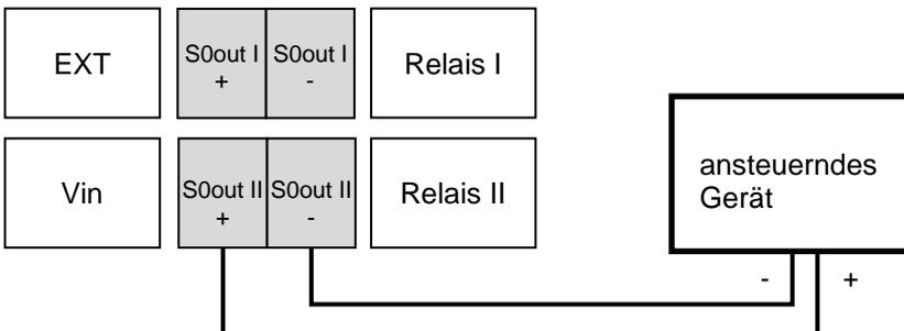
Abbildung 48: Anschlussplan Digital-Out
