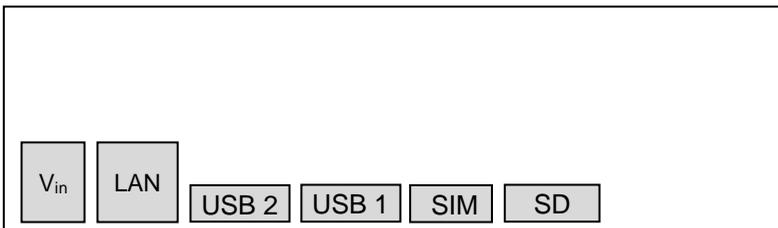
Abbildung 46: Anschlussplan D0-Zähler
