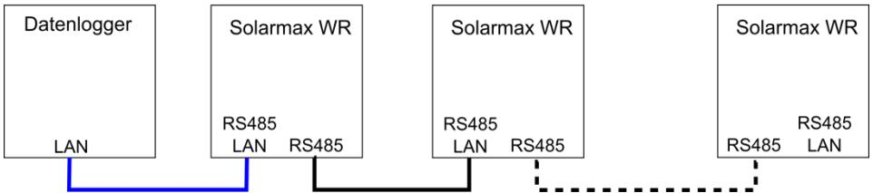
Abbildung 32: Anschlussplan Solarmax
