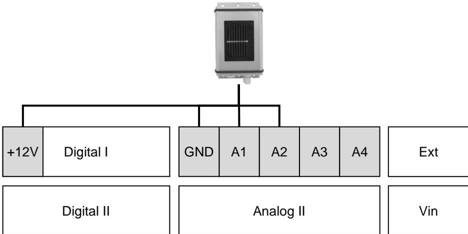
Abbildung 42: Anschlussplan Solarsensor
