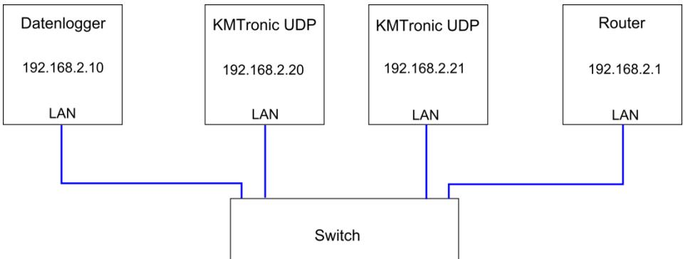
Abbildung 37: Anschlussplan KMTronic Relaiskarte
