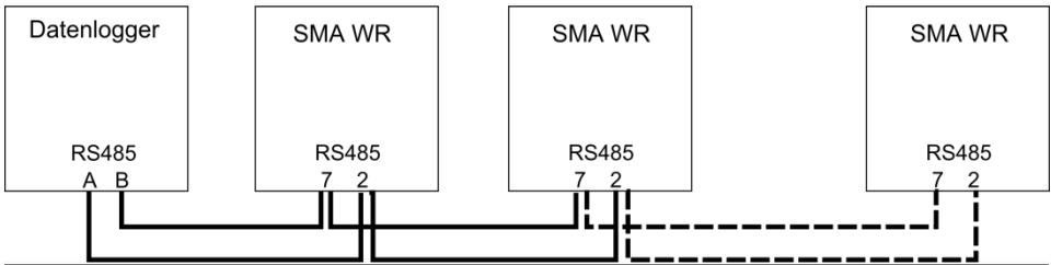
Abbildung 7: Anschlussplan SMA
