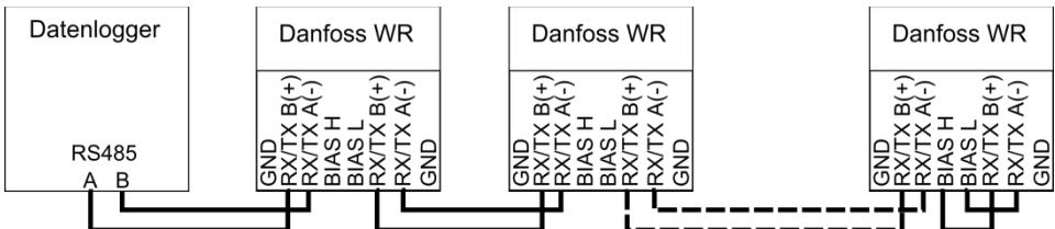
Abbildung 8: Anschlussplan Danfoss
