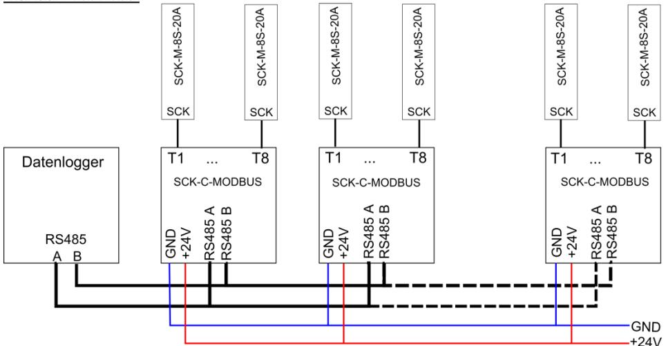
Abbildung 24: Anschlussplan Phoenix DC-Solarcheck
