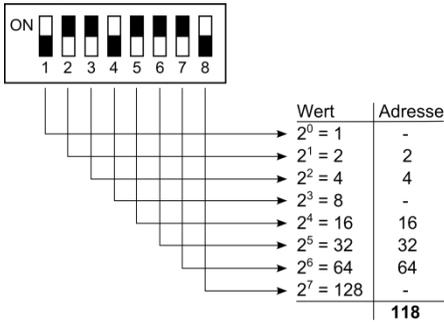
Abbildung 25: DIP-Schalter Phoenix DC-Solarcheck
