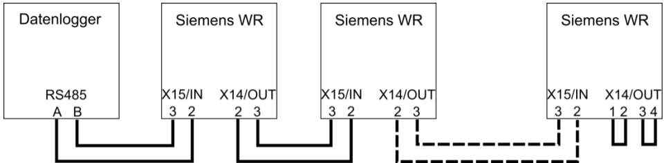
Abbildung 9: Anschlussplan Siemens/Refusol
