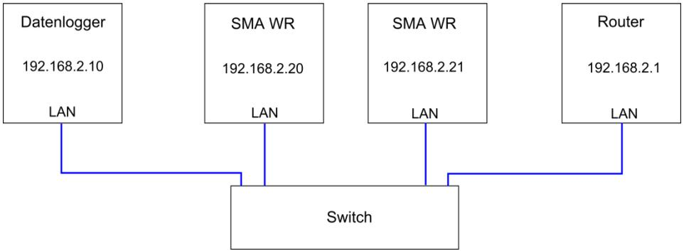
Abbildung 34: Anschlussplan SMA
